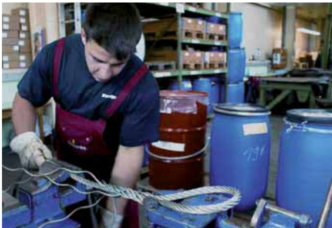
Spleißen eines Drahtseils
