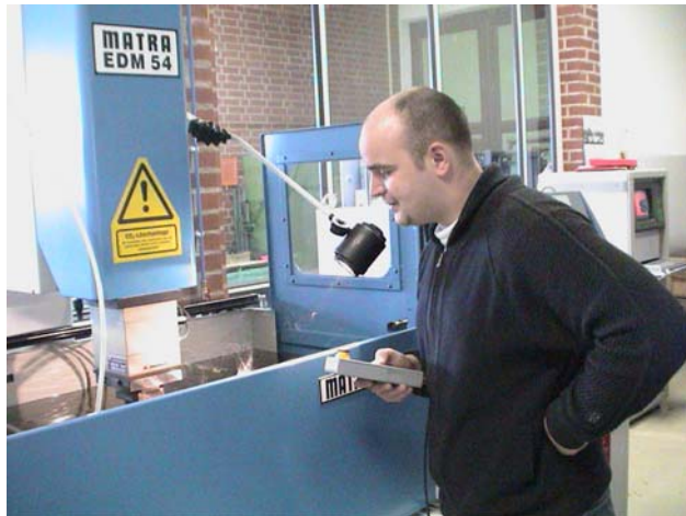
Der Werkzeugmechaniker, Einsatzgebiet Formentechnik beim Einrichten der Erodiermaschine zum Fertigen einer Kontur für ein Spritzgießwerkzeug
