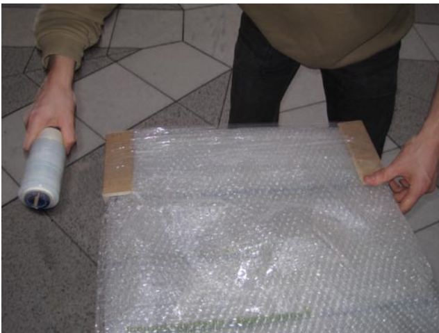
Einpacken mit Bläschenfolie, Pappkanten und Stretchfolie.
