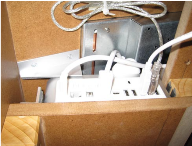
Unterhalb des Bildschirms befindet sich der Media-PC. Angeschlossene Kabel von links nach rechts: Netzteil, Monitorkabeladapter, USB-Trackball, USB-Audioschnittstelle.
