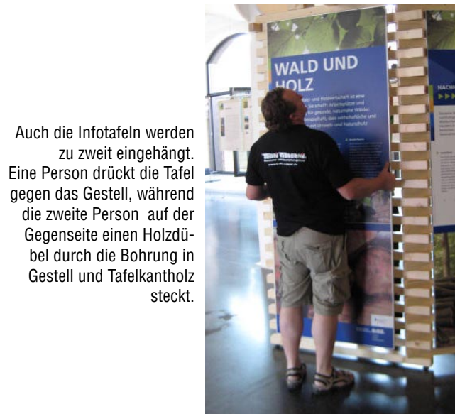
Die Bohrungen im Gestell und dem Stabilisatorkanholz geben den genauen Öffnungswinkel vor des Gestells vor. Durch Holzdübel werden beide miteinander verbunden.
