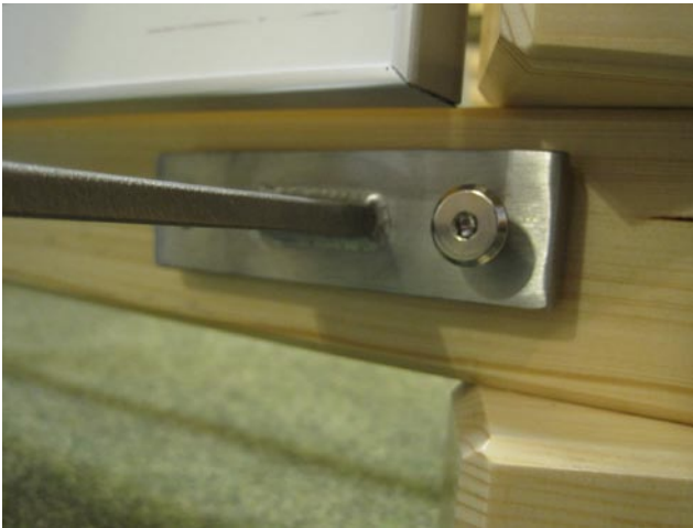
Den unteren Arm des Drehwürfelständers mit zwei 4mm Inbusschrauben ans Gestell schrauben.
