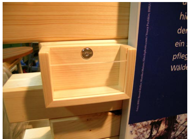
Der Vistenkartenhalter wird mit einer 4mm Inbusschraube am Gestell befestigt.
