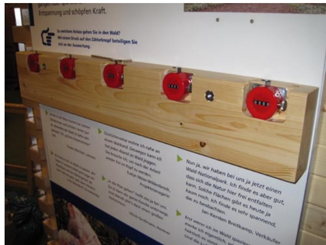
Um die Zähler auf Null zu stellen, die Schrauben auf der Gehäusesoberseite lösen und den Deckel abziehen. Durch Drehen des Rädchens auf der rechten Zählerseite wird dieser auf Null gestellt.
