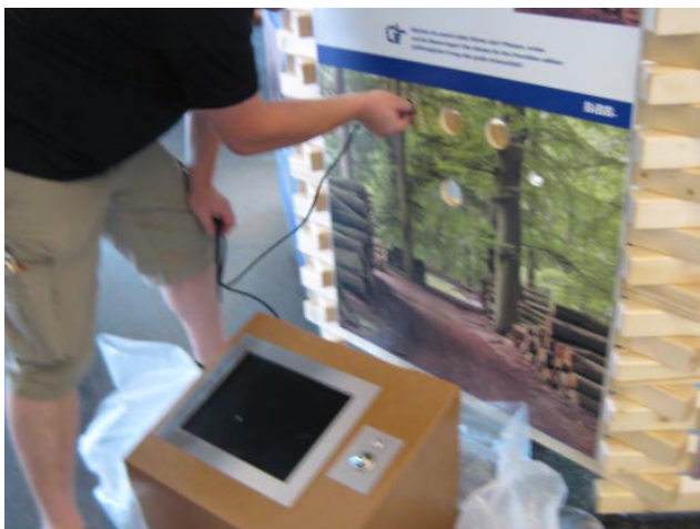
Zum Befestigen des Monitors zuerst die Kabel durch die Bohrungen führen.
