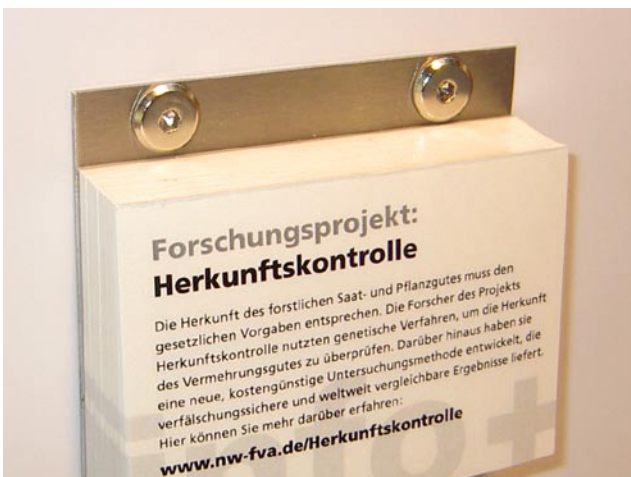
Die Abreißblöcke sind mit doppelseitigem Klebeband auf Edelstahlbleche geklebt.
