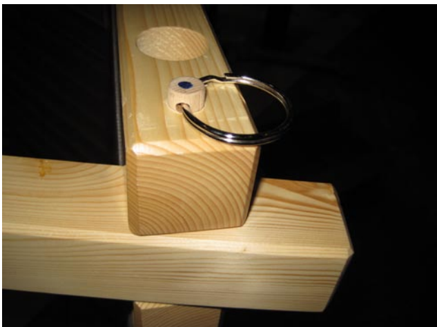
Die Bohrungen im Gestell und dem Stabilisatorkanholz geben den genauen Öffnungswinkel vor des Gestells vor. Durch Holzdübel werden beide miteinander verbunden.
