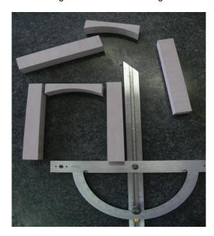
Die zusammengeklebten Teile werden jetzt noch links und rechts auf jeweils 1 Grad gefräst.
