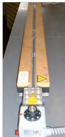
Heizelement zum Abkanten
