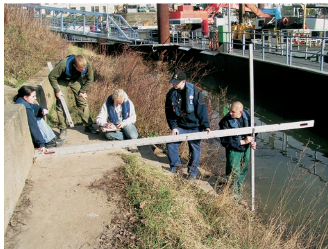
Durchführen einer Staffelmessung für ein Uferanschlussprofil
