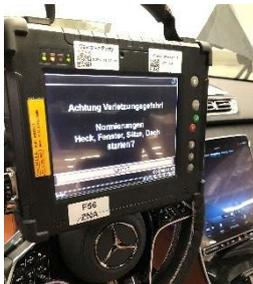
Die Front, Fond und Dachfenster werden normiert. Dies dient dazu um zu testen das die Fensterscheiben sich komplett verschließen lassen. Dabei muss man darauf achten das die Hände nicht zwischen Fenster/ Schiebedach und Türrahmen/ Dachkante sind, da kein Einklemmschutz aktiv ist und das Einklemmen zu Zerquetschungen führen kann.
