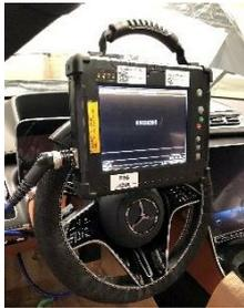
Bevor man mit dem IS-Test beginnt überprüft man nochmals, ob die bereits angelegte Fremdspannungsversorgung noch funktionsfähig ist. Der Schlüssel muss sich immer im Fahrzeug befinden. Bevor man das Diagnosegerät auf das Lenkrad setzt und ansteckt, muss vorab der Lenkradschutz angebracht werden, um Druckstellen und Kratzer vom Diagnosegerät zu vermeiden. Das Diagnosegerät muss mittig und gerade auf dem Lenkrad eingehängt werden.
