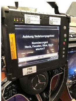
Zum Start der manuellen Prüfung wird der Heckdeckel geöffnet wird. Daraufhin wird der Einklemmschutz des Dachfensters auf Funktion geprüft, indem ein Prüfkörper an die vordere Dachkante der Schiebedachöffnung angelegt wird. Beim Berühren des Prüfkörpers während des automatischen Schließvorgangs muss das Schiebedach sofort wieder stoppen und komplett zurückfahren. Die Beleuchtung des Ablagefachs im Innenraum muss blinken und auf dem Xentri Bildschirm bestätigt werden.
