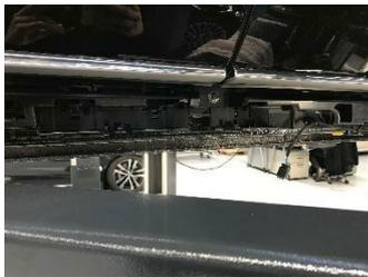
Nachdem ich die Schwellerverkleidung demontiert habe, habe ich festgestellt, dass keine Antenne am dafür vorgesehenen Verbauort montiert war, an der das Kabel vom Steuergerät hätte eingesteckt sein sollen. Diesen Fehler melde ich direkt der zuständigen Meisterei damit in Zukunft darauf geachtet wird und der Fehler nicht wiederholt auftritt. Nach der Meldung bestelle ich die Antenne digital über das Plusrecon-Portal.
