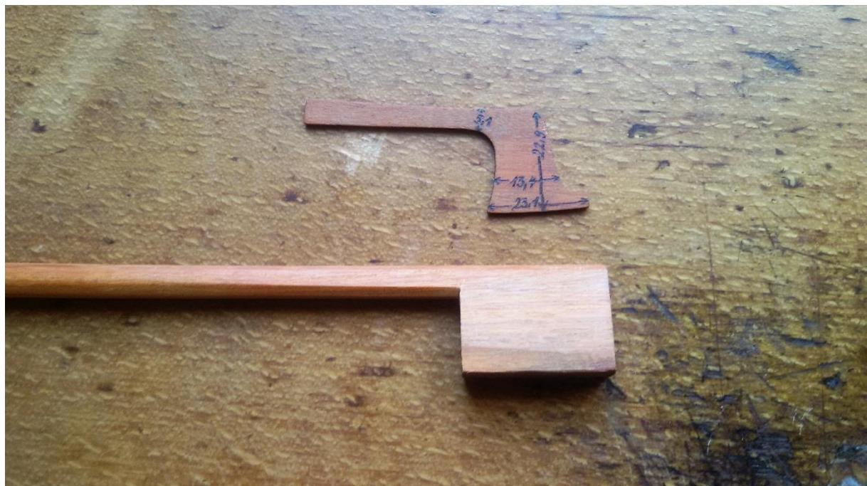
Dann legt er/sie die Schablone im richtigen Winkel an der richtigen Stelle auf die vorbereitete Bogenstange. Er/Sie zeichnet die Schablone mit einem Bleistift auf den Stangenrohling auf.
