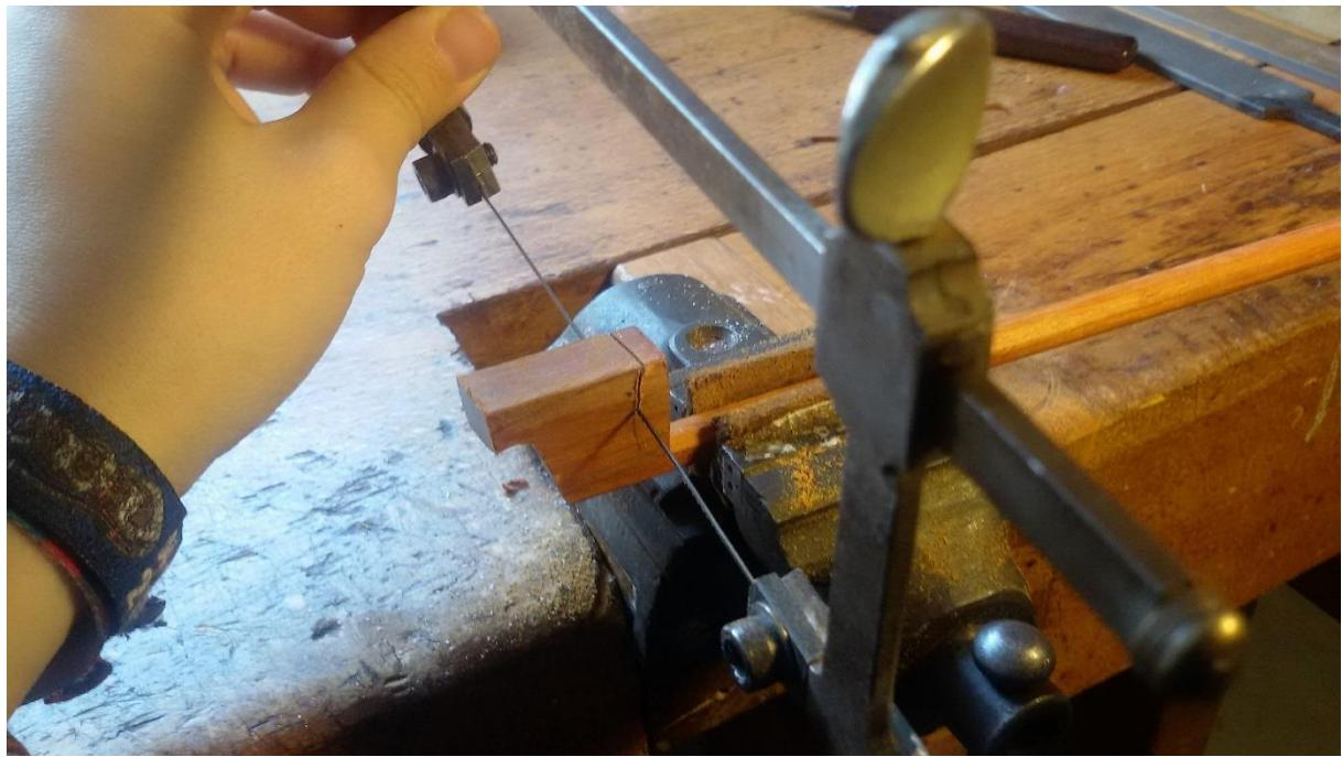
Dann sägt der/die Auszubildende möglichst genau an den aufgezeichneten Linien entlang, so dass der Bogenkopf die gewünschten Maße bekommt.
