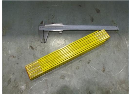
**Abbildung 5:** Strichmaßstab und Messschieber
