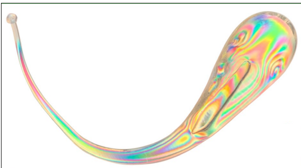
Abbildung 6: Bologneser Träne unter Spannungsprüfer (Quelle: Ragnar Theuerjahr)
