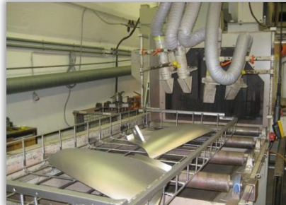
Variante Mechanische Dekontamination: z.B. Abrasiveverfahren
