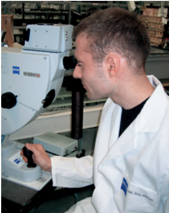
Der angehende Mechatroniker Daniel Veit bei der Justierung einer Hochleistungskamera FF 450 plus zur Beobachtung und Dokumentation am Augenhintergrund.
