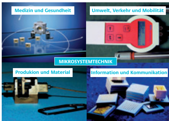
Bild oben links: Fluidikzelle: Mikrofluidisches System mit austauschbarer Mikromischerzelle z. B. zur Dosierung von Medikamenten (Quelle: Bartels Mikrotechnik GmbH)
