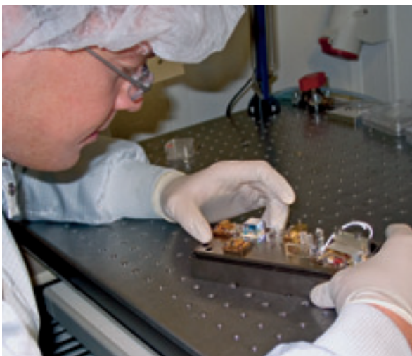
Johannes Dankwardt bei der Justage und Montage von optischen und elektronischen Komponenten eines kompakten „INNOSLAB-Laser“.
