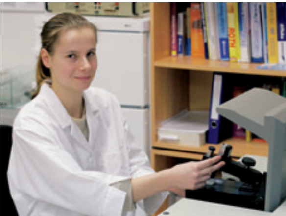
Bettina Arnold, angehende Biologielaborantin, untersucht neue Oberflächenbeschichtungen am Infrarotspektrometer.
