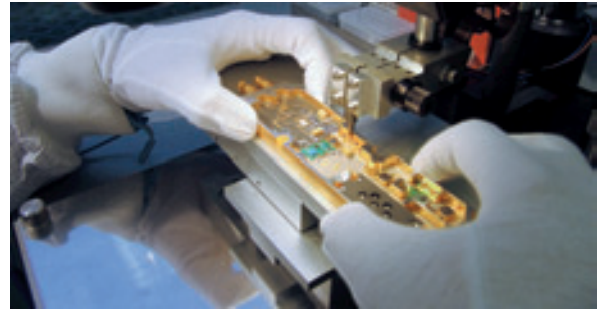
Arbeit einer Mikrotechnologin: Manuelles Bonden mit einem 25 µm Golddraht.
