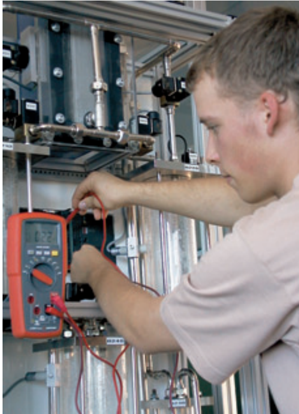
Der angehende Elektroniker Marcel Mehnert bei der Signalverfolgung mit einem Digitalmultimeter.
